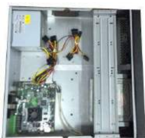
⑧ Vuelva a colocar el soporte. Ajuste el CD-ROM en la posición correcta de modo que el botón del panel frontal esté directamente frente al botón emergente del CD-ROM.
