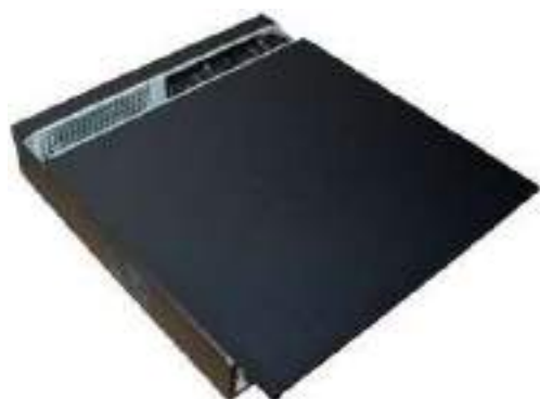
⑨ Asegure el soporte del HDD y coloque la parte superior tapa trasera.
