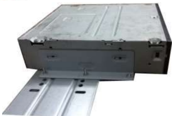
⑥ Instale quemador SATA. Alinee el SATA quemador a las posiciones de los agujeros.
