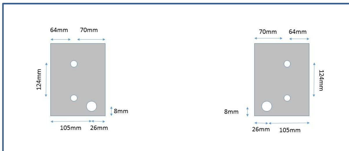
Medidas de fijación al suelo EC-T112S
