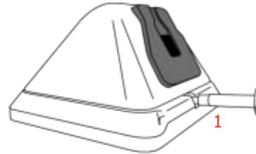
1. Con un destornillador Phillips pequeño, atornille el tornillo de bloqueo desde la parte inferior del panel para asegurarlo a la base.
