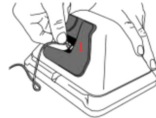
1. Con la fuente de alimentación y el cable incluidos, enchufe el conector cilindrico en el conector cilindrico en la parte inferior de la IQ BASE como se muestra arriba.
